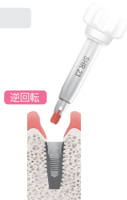
Screw Holderを使用して Pick Up後、除去 ※ Hand Mode
