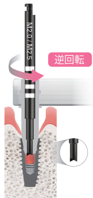
Screw Remove Barを 使用して逆回転
