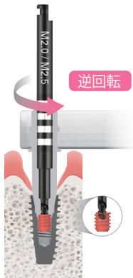
Reverse Cutting Drillを使用し 逆回転(1mm以上の穴生成)
